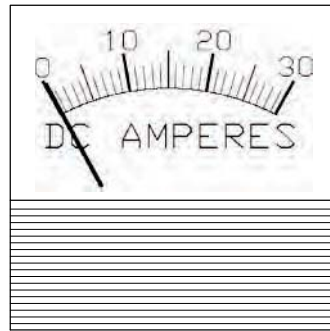
Fig. 16 Ammeter (Amp Meter)
