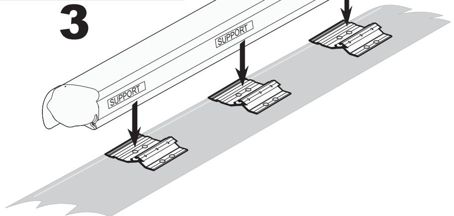
**(DE)** Positionieren Sie die Halterungen an den schon am Fahrzeug vorhandenen Anbringungspunkten. Versichern Sie sich, dass sich die Halterungen entsprechend der Beschriftung "SUPPORT" des Markisengehäuses und folglich entsprechend den Anbringungspunkten der Arme an dem Gehäuse befinden.
